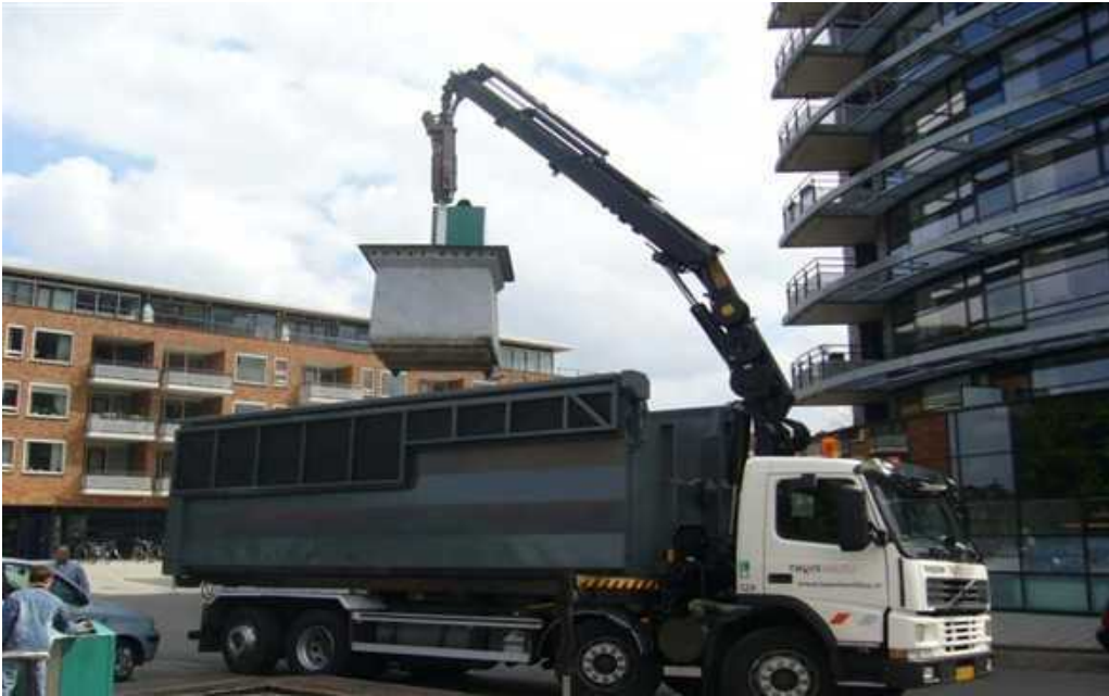
Εικόνα 3: Ειδικό φορτηγό με «παπαγαλάκι» για την αποκομιδή κωδώνων αποθήκευσης γυαλιού και μετάλλου
